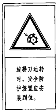
图 A.4 旋耕刀防护装置安全标志
